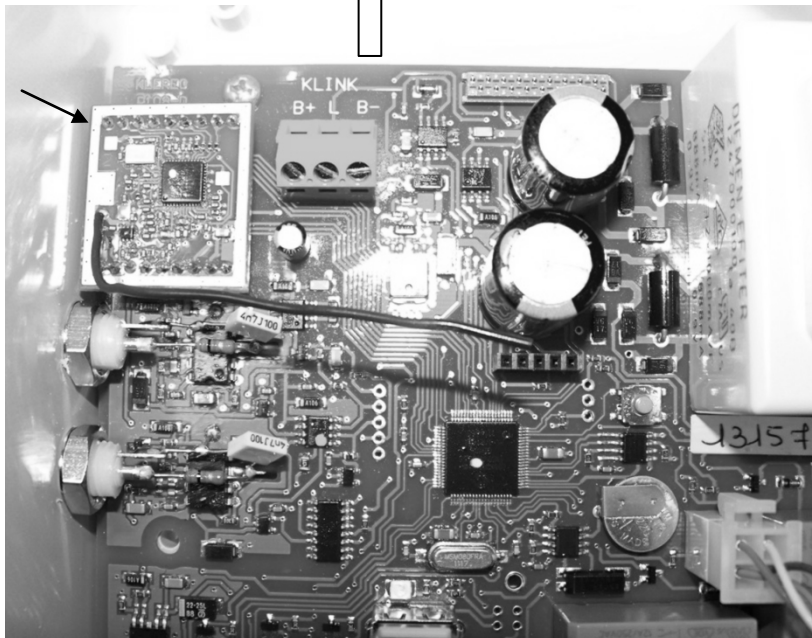
Figure 5. Insertion de la carte RF sur la carte électronique contenue dans le Klereo Kompact
